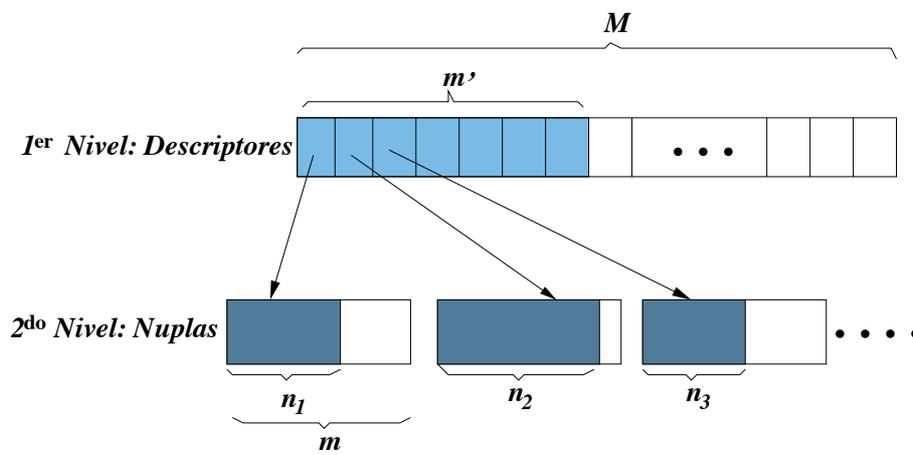
Si cada trozo de lista tiene capacidad para mantener a lo sumo  $m$  elementos; para mantener los trozos similares en tamaño colocamos la restricción de que cada trozo puede mantener como mínimo  $\left\lceil \frac{m+1}{2} \right\rceil$  elementos.
